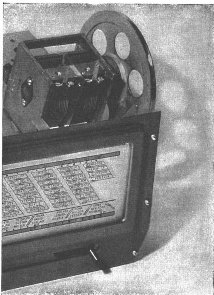
Fig. 9.4. - Ad ogni spostamento dell'indice sulla scala parlante corrisponde uno spostamento delle lamine mobili del condensatore variabile. Il movimento è comunicato con una funicella fissata alla puleggia fissata all'asse del condensatore variabile. Nella figura è visibile un condensatore variabile a due sezioni.
