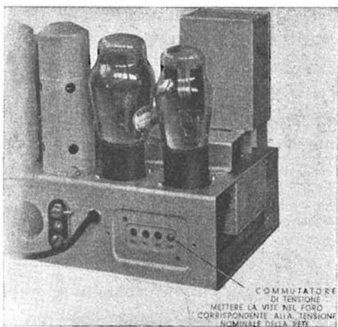
Fig. 11.3. - Cambio tensioni in apparecchio commerciale.
