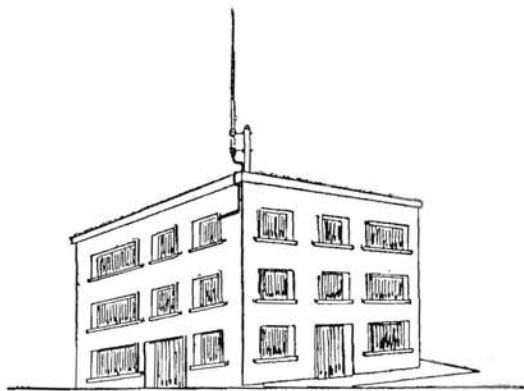
Fig. 10.10. - Esempio di antenna verticale a tubo metallico.
