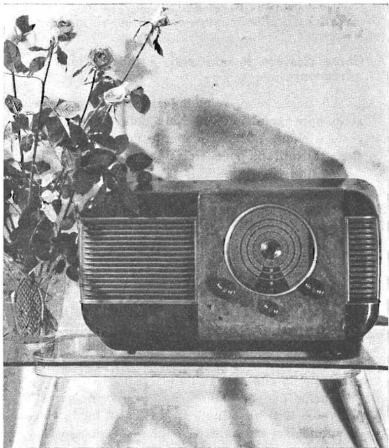
Fig. 12.3. - Apparecchio AMiFM ossia a modulazione di ampiezza (per la ricezione delle emittenti ad onde medie, corte e cortissime) ed a modulazione di frequenza (per la ricezione delle emittenti ad onde ultracorte). Possiede 12 valvole più l'occhio magico.
